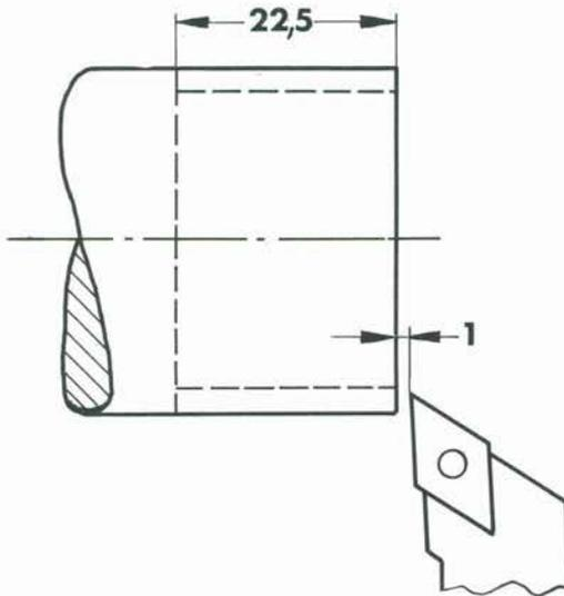
L'outil de tournage doit se déplacer de 23,5 mm en direction Z. La position qu'occupera l'outil de tournage est celle illustrée sur le croquis.
