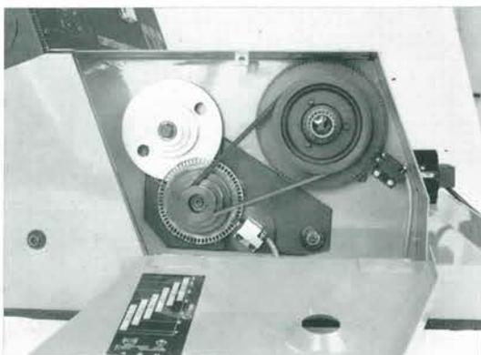
1. Le capteur d'impulsions 1 enregistre la vitesse de rotation par le plateau à trous fixé sur la broche principale et la transmet au calculateur. Le microprocesseur (calculateur) opère la conversion: La vitesse de rotation a telle et telle valeur; quelle devra dès lors être la valeur de l'avance pour obtenir le pas de filetage programmé? Le résultat est immédiatement transformé en instruction et retransmis au moteur d'avance.
