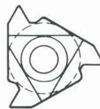
Avec le COMPACT 5 CNC nous utilisons des plaquettes réversibles à profil partiel afin de pouvoir tailler des filetages en une seule gamme de pas.
