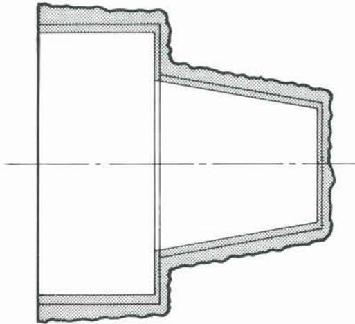
Une pièce peut également être réalisée par une succession de passes en contournage.
