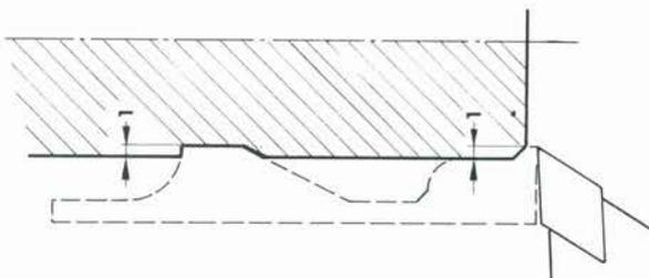
Attendu que nous avons fixé la profondeur de coupe maximale à 1 mm, il faudra dans le cadre de cet exemple positionner l'outil de tournage à  $X = -1$  mm de la surface cylindrique, et ce pour la première passe.
