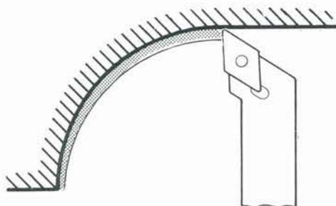
Profondeur de passe maximale à l'extrémité du rayon: 0,3 mm max. pour  $\alpha = 93^\circ$
