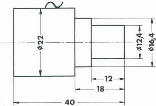
Réaliser la pièce illustrée ci-contre. L'outil de tournage se trouve à la position repérée sur le croquis. Les cycles doivent débiter au point A.
