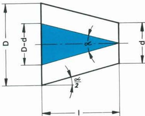
$$\begin{aligned} \text{Cône } 1:K &= \frac{\text{Différence de diamètre}}{\text{Longueur de cône}} \\ &= \frac{D-d}{L} \end{aligned}$$
