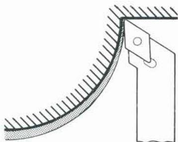
Profondeur maximale de passe au début de 0,3 mm pour  $\alpha = 93^\circ$ .
