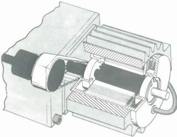
Une rotation des moteurs du tour COMPACT 5 CNC est subdivisée en 72 pas. Cela signifie qu'un pas équivaut à un angle de rotation de 5° ( $360:72 = 5^\circ$ ).
